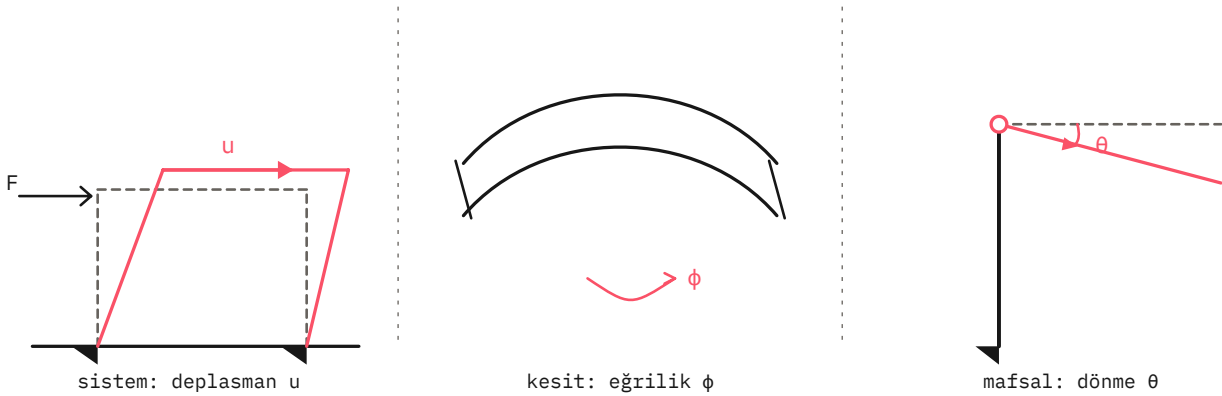
Görsel 2 - Her süneklik oranının nerede ölçüldüğü: deplasman u tüm yapı üzerinde, eğrilik \phi bir kesitte, dönme \theta bir plastik mafsalda
